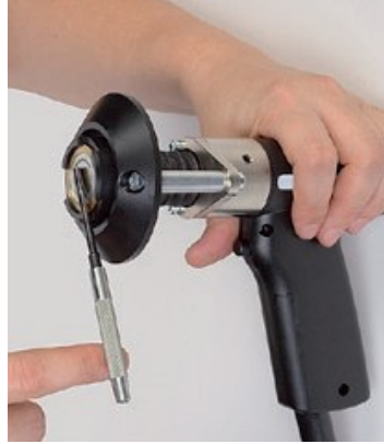
2. Den Magnetbolzenhalter heraddrehen.
