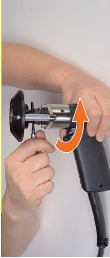
1. Die Magnethülse der Schweißeinheit an der Pistole lösen.
