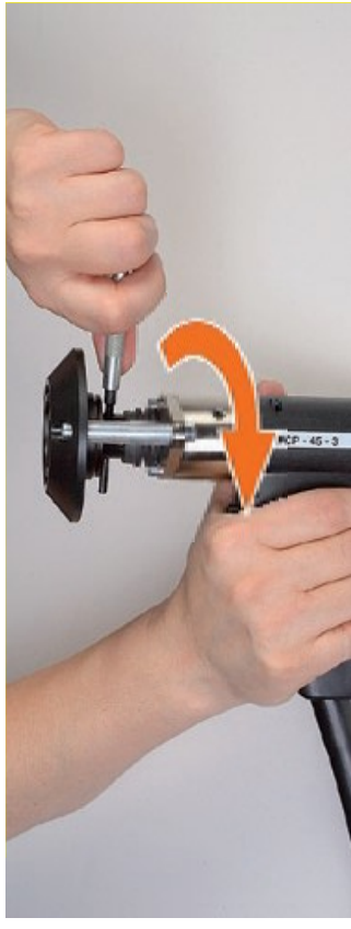
8. Nach dem Zusammenbauen in umgekehrter Reihenfolge die Magnethülse der Schweißeinheit unbedingt wieder kräftig anziehen .
