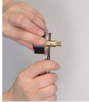
4. Die Isolierhülse lösen.
