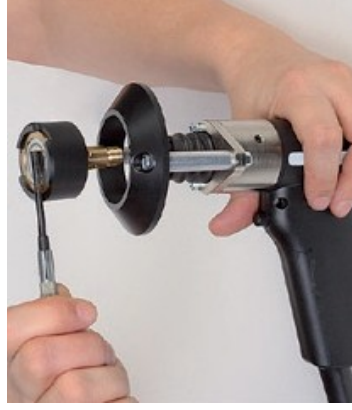
3. Den Magnetbolzenhalter anheben.
