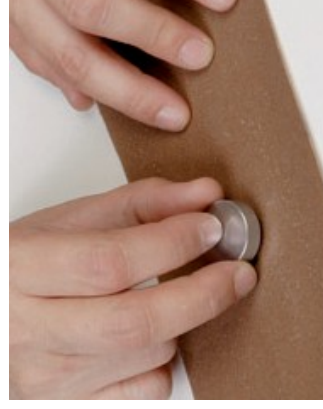
Haftmagnet und Kontakttring können anstatt ausgetauscht oft auch gereinigt werden. Dazu einige Male mit der verschmutzten Seite über feines Schleifpapier bewegen.
